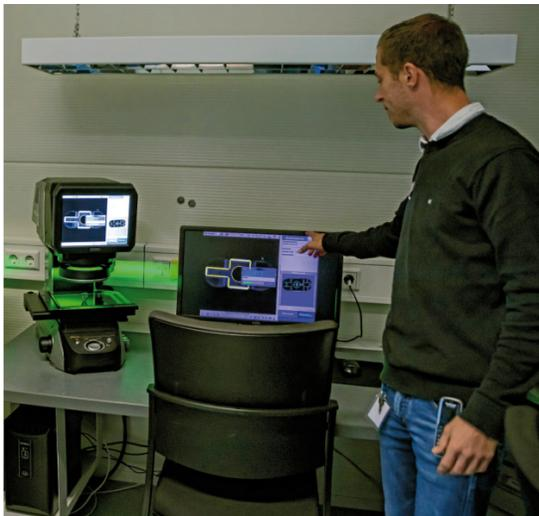
Präzision steht bei Medi-G an erster Stelle: Thomas Stolz arbeitet an einem Messgerät, das lasergestützt hochauflösende Aufnahmen der medizinischen Bauteile fertigen kann.
